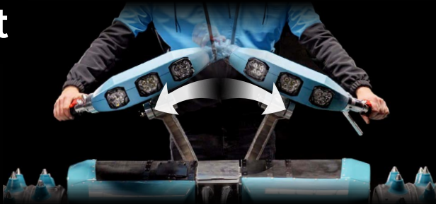
Trittbrett und Lenker nach beiden Seiten hydraulisch 35° schwenkbar
